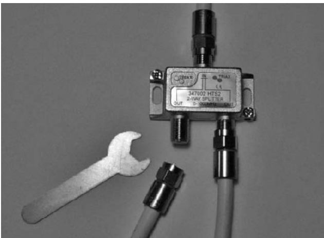
Rigtig antenneinstallation udføres med F-Connectorer
